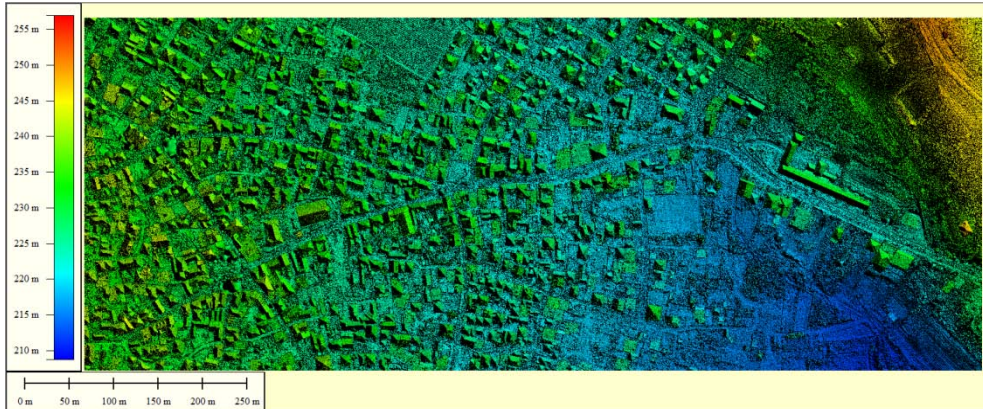
Εικόνα 8. Παραχθέν DSM με βήμα 0.075 m από το λογισμικό Agisoft
