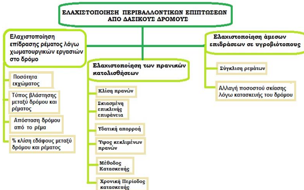
Σχεδιάγραμμα 1. Ιεραρχική ανάλυση Μείωσης Περιβαλλοντικών Επιπτώσεων από έργα Δασικής Οδοποιίας (Πηγή: Coulter et all, 2002)
