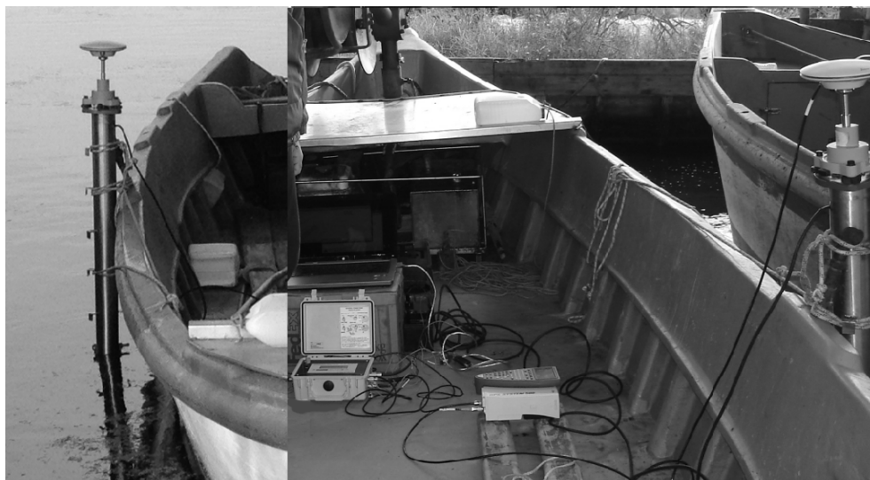
Σχήμα 2: Το ικρίωμα με τον προβολέα της ηχοβολιστικής συσκευής και την κεραία του δέκτη GPS (αριστερά) και οι συσκευές ελέγχου (δεξιά).
