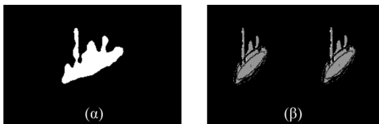
Εικόνα 4. Μετά την πρώτη φάση του αλγορίθμου προκύπτει η δυαδική εικόνα (Εικόνα 4α) και μετά το πέρας του εντοπίζονται επιτυχώς η εγγεγραμμένη και η περιγεγραμμένη έλλειψη καθώς και το σημείο μέγιστου πλήγματος (Εικόνα 4β).
